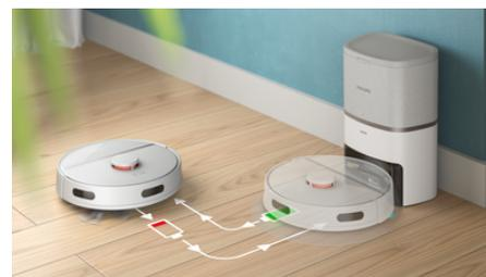
Zmogljiva litij-ionska baterija s kapaciteto 4800 mAh zagotavlja čas delovanja do 200 minut, zato lahko z enim polnjenjem očistite več kot 150 m, ne da bi vas skrbelo, da bo zmanjkalo energije. Ko se baterija izprazni, se robot samodejno vrne na postajo, da se napolni. Ko je baterija napolnjena, se bo vrnil na mesto, kjer je prenehal, in nadaljeval s čiščenjem.
